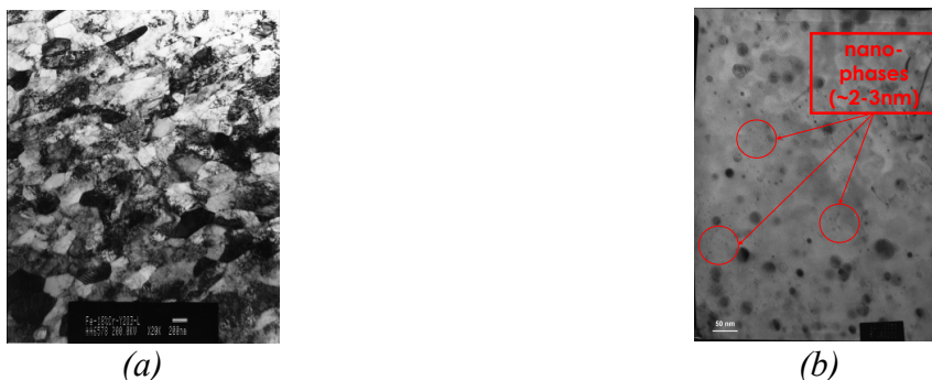
Figure 1 : micrographies MET d'un acier ODS (a) consolidé par filage à chaud (direction radiale) ; (b) observation de la précipitation des nano-renforts intragranulaire
