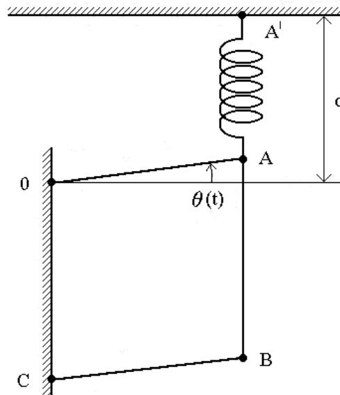
Entre A et A' est disposé un amortisseur à fluide de coefficient  $\alpha$ .
