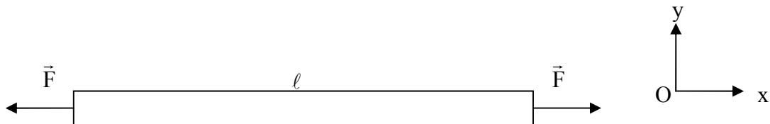
Une barre rectiligne de section circulaire  $S$  de diamètre  $d$  et de longueur  $\ell$  est soumise à chacune de ses extrémités à une sollicitation  $\vec{F}$ . On désire trouver le diamètre minimum à utiliser pour que la barre résiste aux sollicitations, ainsi que l'allongement  $\Delta\ell$  qui en résulte.
