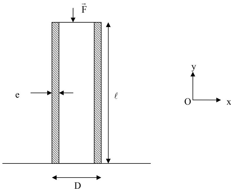
Un poteau tubulaire de diamètre extérieur  $D$ , de hauteur  $\ell$  et d'épaisseur  $e$ , repose sur le sol et est soumis à une sollicitation  $\vec{F}$ .
