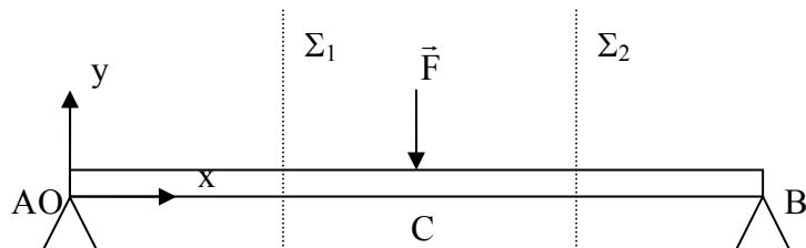
Dans ce cas l'équation statique nous donne rapidement les réactions aux appuis  $R_A = R_B = F/2$
