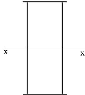
Le cadre est construit de façon parfaitement symétrique par rapport à l'axe d'oscillation; posé sur son support par l'intermédiaire de 4 roulements à billes, il est en équilibre indifférent. L'appareil est livré avec un jeu de masses additionnelles en laiton, qui peuvent être engagées dans les prolongements des petits côtés du cadre.
