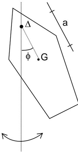
Un pendule pesant est un solide de forme quelconque pouvant tourner autour d'un axe horizontal  $\Delta$ . L'amortissement dû à l'air étant très faible, on peut considérer qu'il est soumis uniquement à son poids et à la réaction du support. Dans ces conditions, vous verrez en cours de mécanique que le pendule oscille selon un mouvement sinusoïdal de période:
