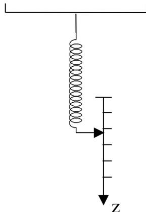
Accrocher le ressort sous la balance; puis, fixer son extrémité inférieure à l'index de la règle (qui est en fait un pied à coulisse muni d'un support), en étirant très légèrement le ressort et en veillant à la verticalité du ressort.
