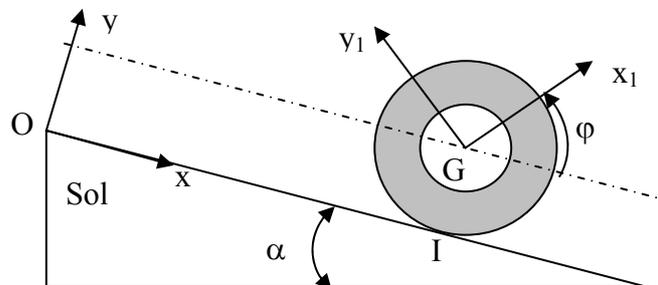
**21:** En utilisant la relation du champ des vitesses, donner la relation entre la vitesse  $\dot{x}$  du point  $G$  et la vitesse de rotation  $\dot{\phi}$  du cylindre.
