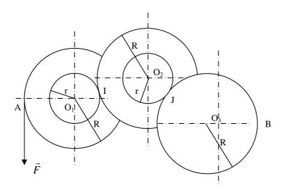
**21:** Exprimer la relation donnant la vitesse de rotation  $\omega_3$  de la roue(3) en fonction de  $\omega_1$ , celle de la roue(1), en utilisant la relation du champ des vitesses.
