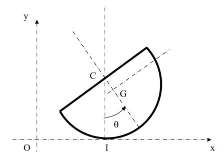
41: Déterminer la vitesse  $\overrightarrow{v_G}$  en utilisant la relation du champ des vitesses, en fonction de b, R,  $\theta$ ,  $\dot{\theta}$ .
