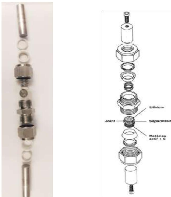
Figure A.6 : Vue éclatée d'une batterie de laboratoire de type Swagelok®
