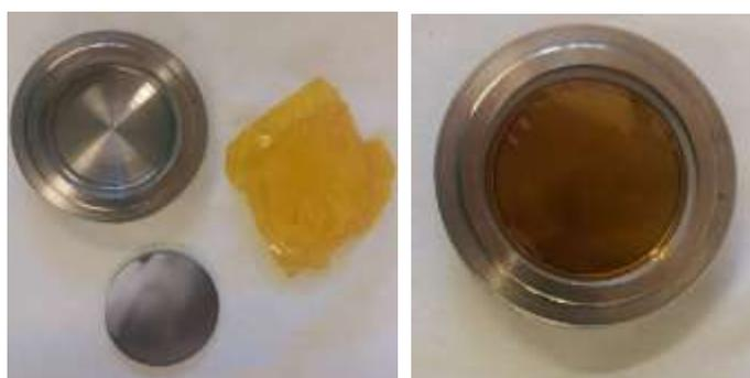
Figure A.3 : Support de silicium avec le film de Kapton utilisé pour les mesures de diffraction des rayons X
