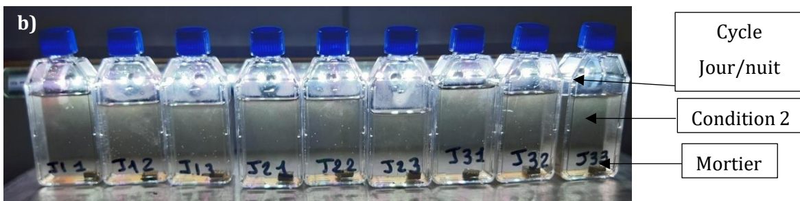
Figure 36. Dispositif expérimental de la dissolution du mortier immergé dans la condition 1 (a) et condition 2 (b).
