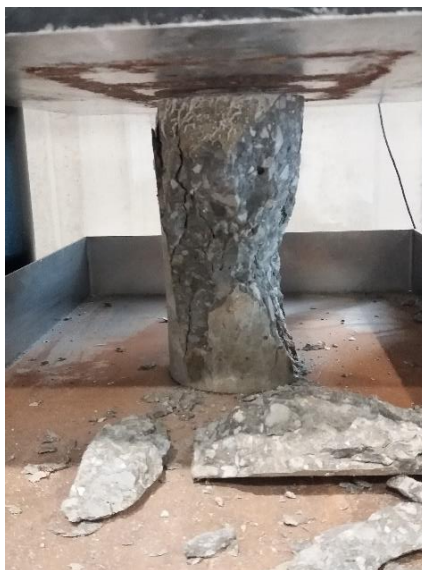
Figure 26. Essai de compression sur éprouvette de béton ( \varnothing 110 mm \times 220 mm) après 3 mois d'immersion in situ
