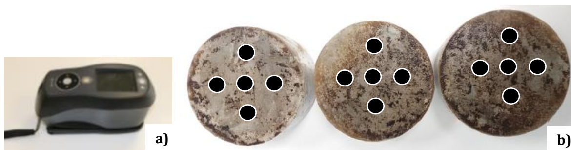
Figure 31. Spectrophotomètre utilisé (Ci60 (X-Rite)) (a) ; disposition de l'emplacement des mesures au spectromètre réalisées (ronds noirs) (b)
