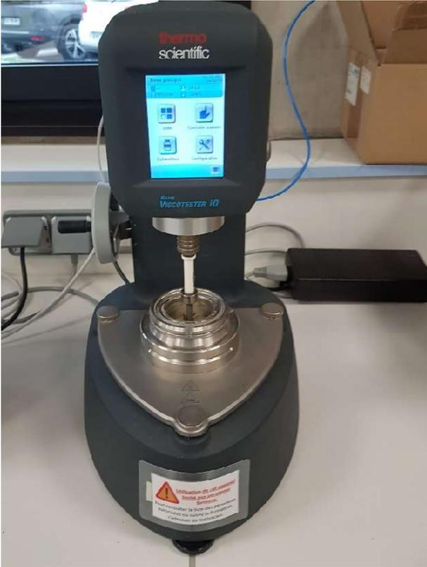
Figure II. 3 – Modèle du Viscosimètre HAAKE Viscotester iQ
