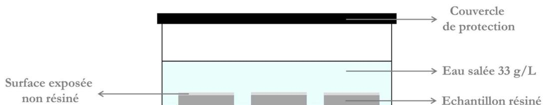
**Figure II. 20 - Schéma du montage pour la diffusion naturelle des ions chlorures.**
