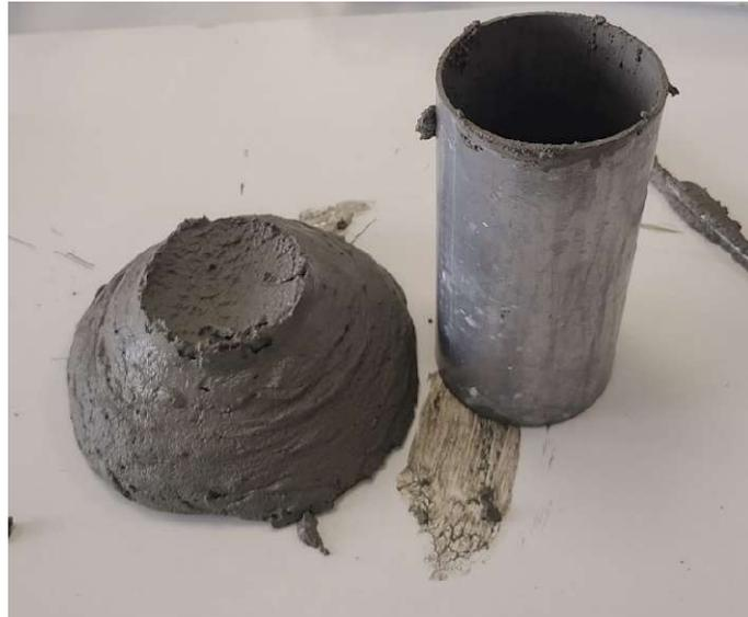
**Figure II. 7 - Cylindre droit pour essai à l'état frais.**
