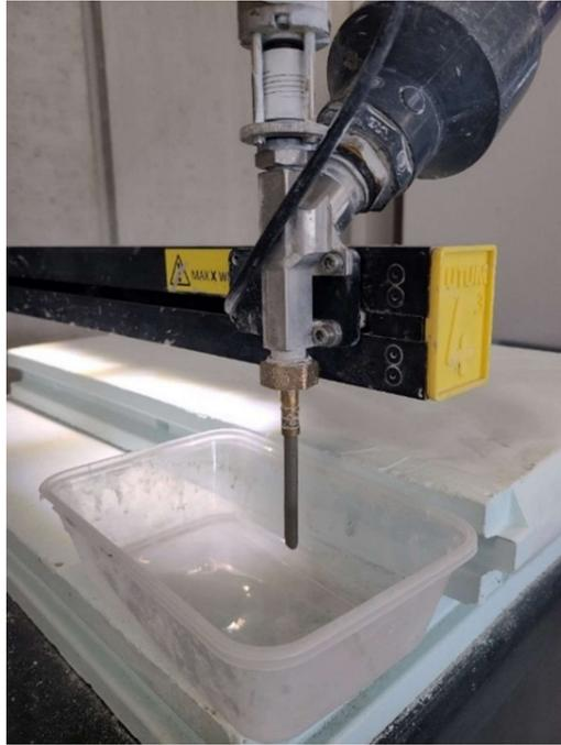
*Figure II. 9- Exemple de test d'extrudabilité.*
