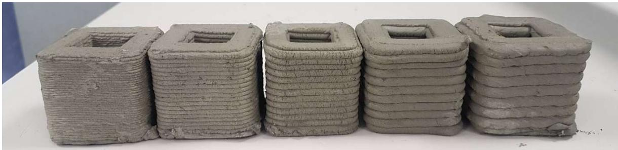
**Figure IV. 8- Cubes à couches d'épaisseurs différentes de 1, 2, 3, 4 et 5 mm.**
