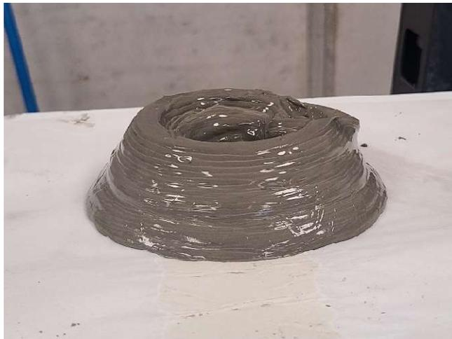
**Figure III. 15- Indice de constructibilité 1 pour la formulation C100G0E40.**
