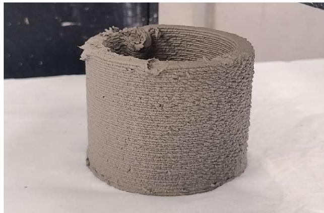
**Figure III. 17- Indice de constructibilité 3 pour la formulation C50G50E40SP1,5.**
