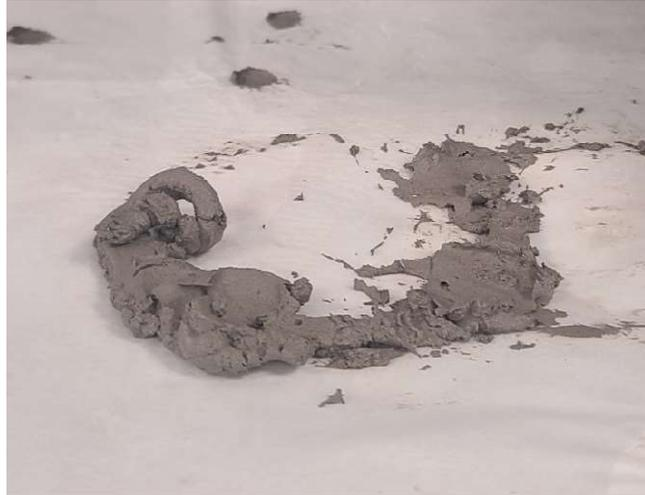
**Figure III. 14- Indice de constructibilité 0 pour la formulation C50G50V0,25.**
