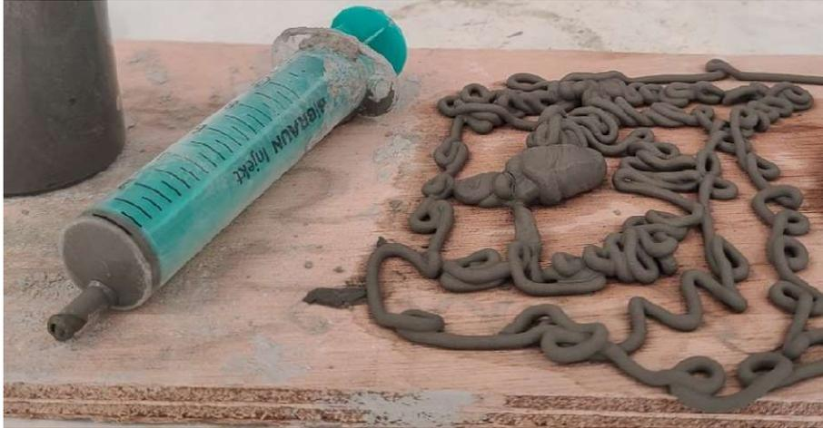
*Figure II. 8 - Illustration de l'extrusion à la seringue.*
