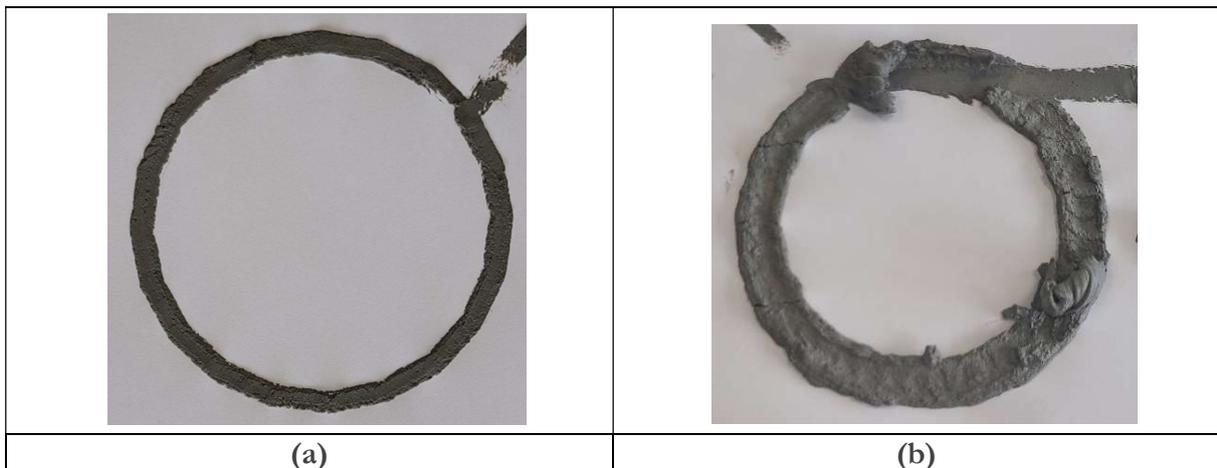
*Figure II. 12 - Exemple de cercle de débit/vitesse en sous-extrusion (a) et en sur-extrusion (b).*
