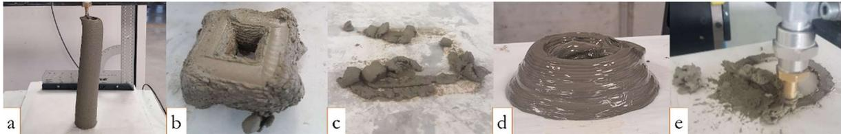
*Figure II. 10- Illustration des principaux défauts possibles a) déformation b) excès de matière (sur-extrusion) c) ligne non continue/manque de matière (sous-extrusion ou pas d'extrusion) d) écroulement sous son propre poids e) bulle d'air.*
