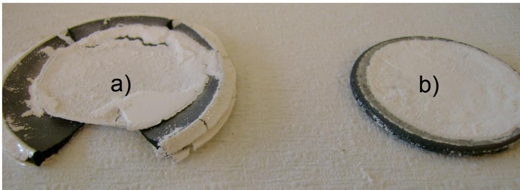
Figure 12 : a) Pastille réalisée avec des disques d'alumine  $\Phi=30\text{mm}$  b) Pastille réalisée avec des disques d'alumines  $\Phi=60\text{mm}$
