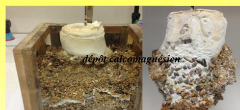
Le dépôt calcomagnésien joue le rôle de ciment naturel liant des différents sédiments (sable, coquilles et gravier).
