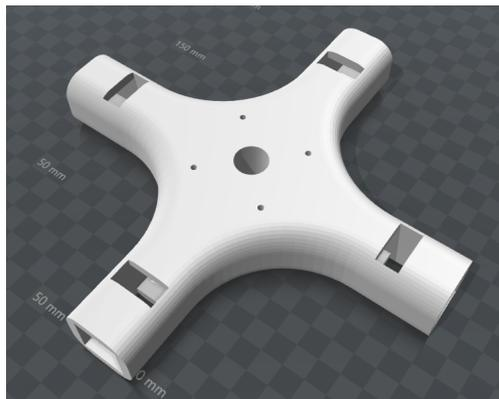
J'ai donc refait un modèle, plus fin et moins lourd car plus petit et dépourvu du système de clips. Ce modèle est composé de cinq parties : la croix centrale et les quatre extrémités des bras de la croix. Les deux étant fixés grâce à de petites vis. En imprimant ce modèle, nous avons pu voir la fiabilité de l'imprimante concernant le diamètre des trous débouchants. De plus, nous avons remarqué que sur les congés (arrondis) des croix, les arcs de cercle sont divisés en une multitude de surface
